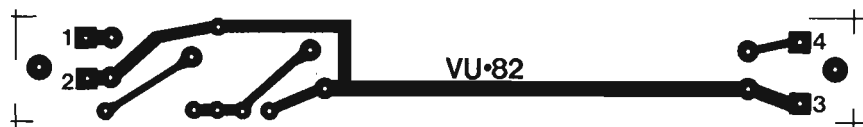
Fig. 6 - Circuito stampato, riprodotto in grandezza reale e realizzato su una basetta rettangolare di materiale fenolico presente nella scatola di montaggio.
